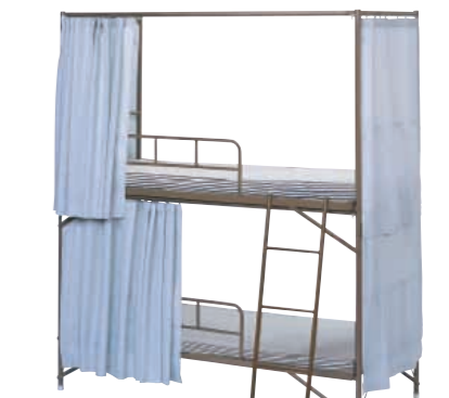
ADB-2170C ¥113,400(108,000) W1970×D910×H2230% 主柱/φ32パイプ、床枠/3×40×40%山形鋼、ボトム/フープ張り ●サイドレール・ハシゴ付 ●三方防炎カーテン付(カラー/グレー) マットレス(別売) ※写真のマットレスは KM-711-A ¥17,472(16,640)×2
